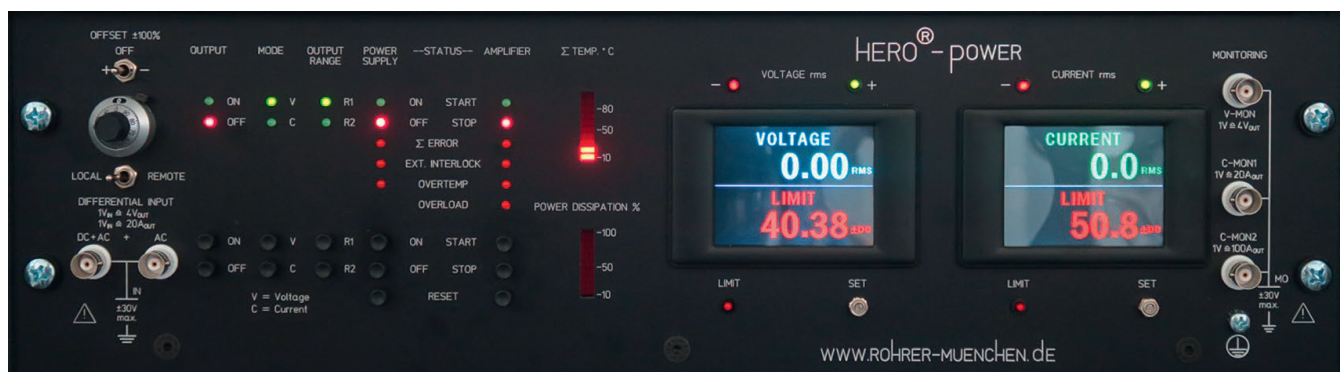
Frontplatte mit den Bedienelementen des Leistungsverstärkers aus der PA-Serie von Rohrer. © Rohrer
